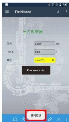
2) 在通讯过程中，HART 智能终端屏幕提示“连接断开”，请检查蓝牙调制解调器是否由于触碰等原因未处于正确的（“ON”或“ON+250Ω”）位置。
